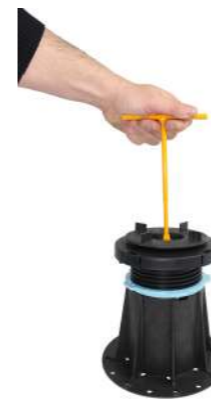
TBR-AK Herramienta. Llave ajustable. Con esta llave conseguimos regular la altura con la cabeza autonivelante. Se puede usar en la instalación finalizada o en el momento de la colocación de las baldosas.
